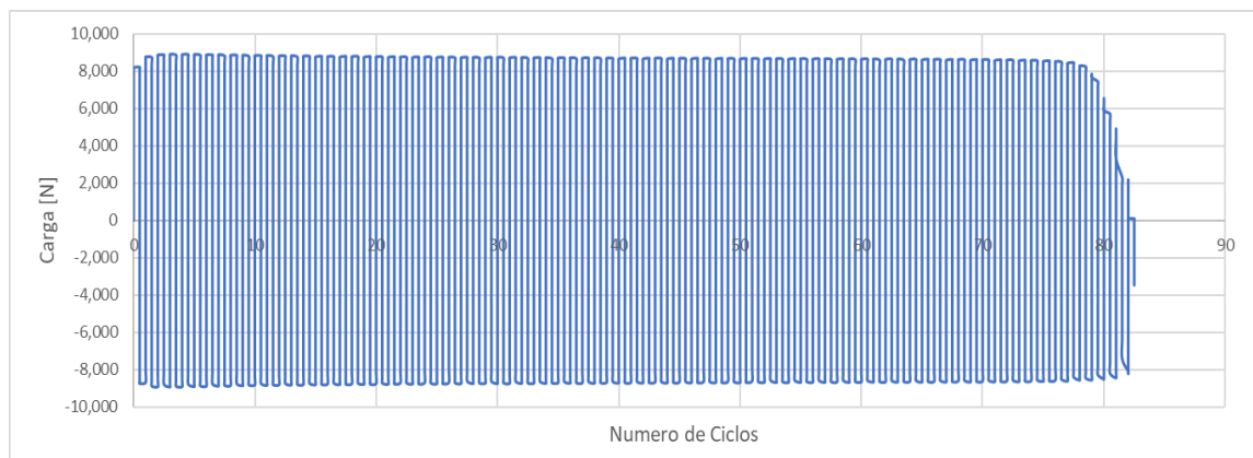
Figura 13. Fuerza vs ciclos del aluminio.
