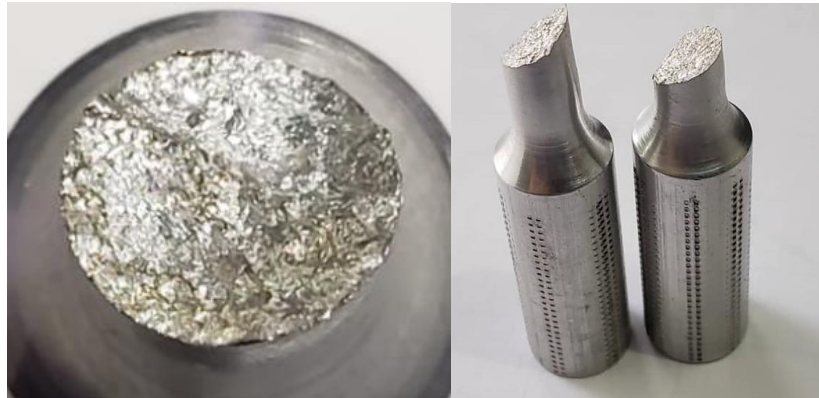
Figura 18. fractura del aluminio.
