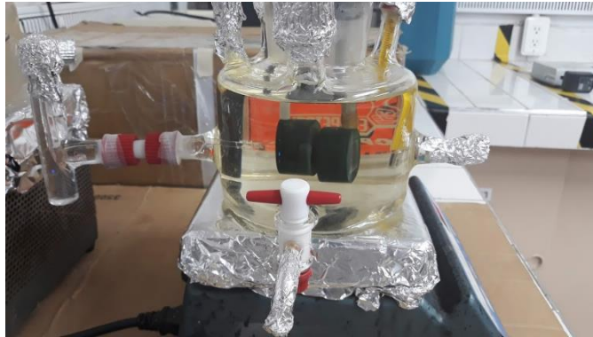
Figura 13 Celda electroquímica con llave acoplada, para ensayo biótico
