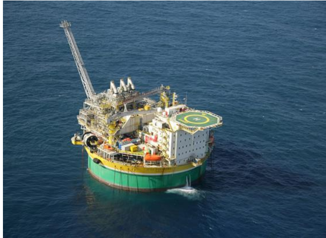
FIGURA 4. Plataforma Sevan Piranema (FPSO Monocolumna)
