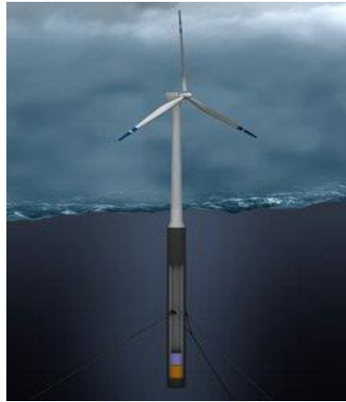
FIGURA 10. SPAR como fuente de Energía Eólica
