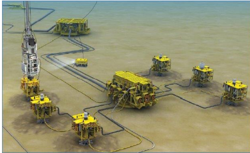
FIGURA 5: Esquema de Sistema Submarino de Producción.
