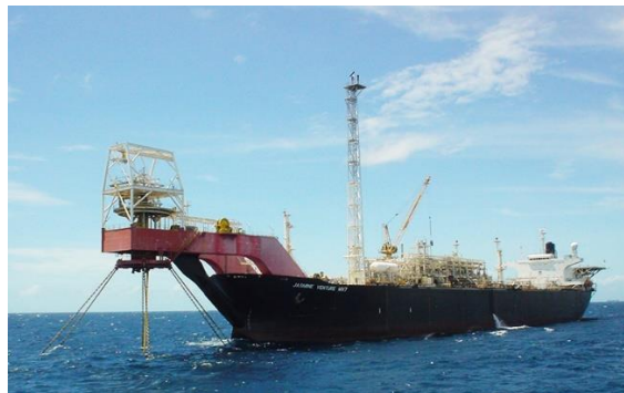
FIGURA 14. FPSO Jasmine Venture MV7 Campo Jasmine Thailand con anclaje de tipo Torreta (Torreta externa).
