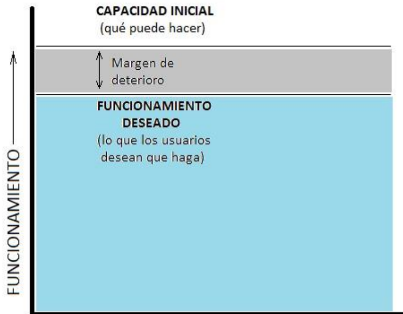
Figura 13. Margen de deterioro
