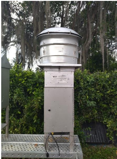
Figura 11. Estructura exterior muestreador ambiental PM10
