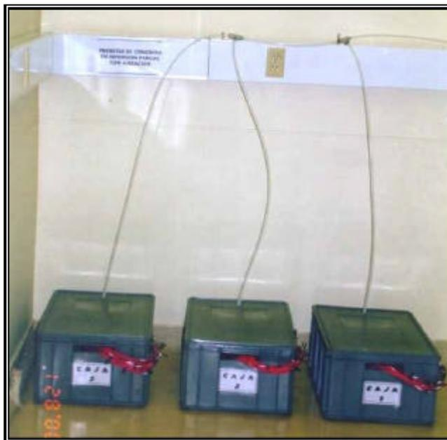
En la parte interior de las cajas, se instaló una conexión de mangueras que permitían la circulación continua de aire proveniente de bombas anexas al sistema (Figura 30). La aireación proporcionó una mayor cantidad de oxígeno disuelto alrededor de las probetas, induciendo su difusión a través de los poros del concreto con el fin de promover el proceso de corrosión del acero de refuerzo.
