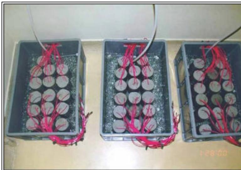
El sistema permaneció cerrado con el objeto de evitar el aumento en la concentración de NaCl en la solución por pérdida de agua, ocasionada por el efecto de arrastre que genera el flujo de aire suministrado al sistema de inmersión, así como por la temperatura del sistema.
