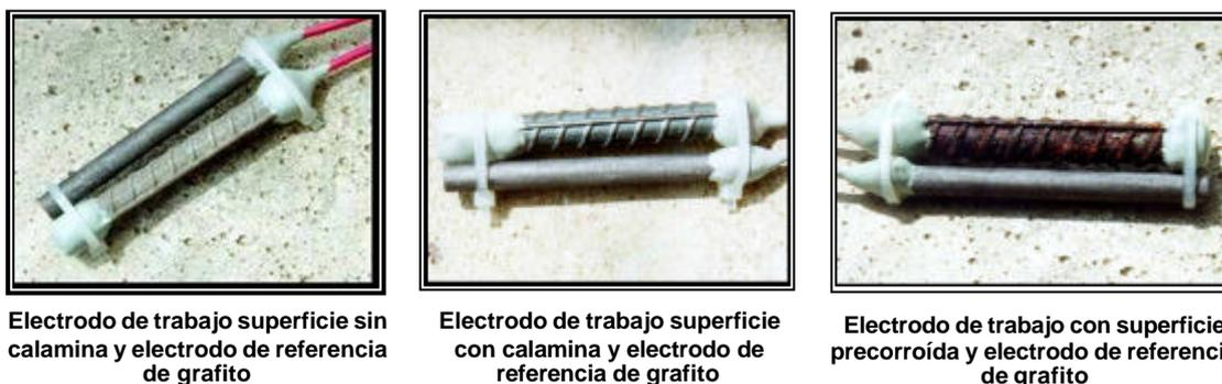
El Cuadro 9 muestra el número de celdas electroquímicas y de electrodos, para el desarrollo de este proyecto referido a cada tratamiento superficial, por diseño de mezcla. Para cada sistema electroquímico se elaboraron 8 probetas de concreto bajo las mismas condiciones, con el fin de obtener representatividad a la hora de realizar el análisis electroquímico de los espectros.
