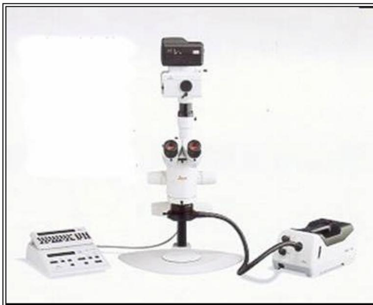
La lupa estereoscópica junto con sus componentes se muestra en la Figura 34. Vista lateral de la lupa estereoscópica LEICA MZ APO, junto con la descripción de sus componentes. Presenta una amplificación de imagen hasta 80X, cuyas divisiones pueden conmutar en nueve posiciones de aumento iniciando en 12.5X. Las imágenes son capturadas por el software Pixera Estudio versión 1.2.
