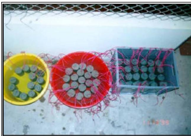
El fraguado normalizado se realizó durante 28 días en inmersión total en agua, tiempo en el cual la razón de cambio de la resistencia a la compresión tiene los mayores incrementos. Para tiempos de fraguado mayores a 28 días, dicha razón de cambio incrementa levemente, alcanzando su máximo valor alrededor de los 120 días. Los valores de resistencia a la compresión obtenidos para los tiempos de fraguado citados, son comparables, esto indica que no se necesitan fraguados mayores a 28 días.
