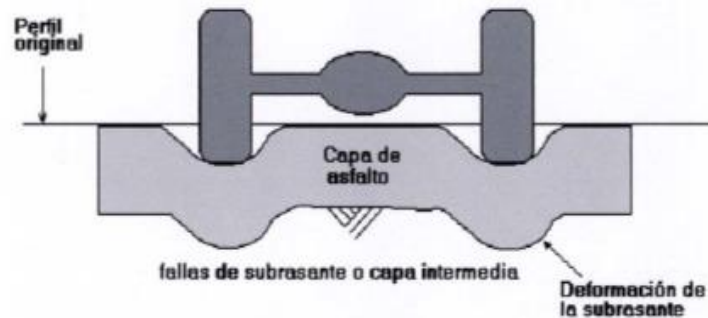
Figura 2. Ahuellamiento en la carpeta de rodadura.
