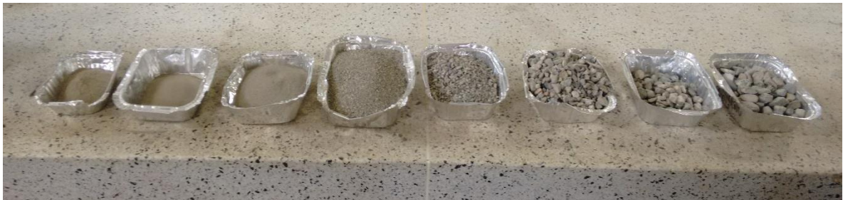
Figura 7. Agregados retenidos en cada tamiz en el análisis granulométrico.
