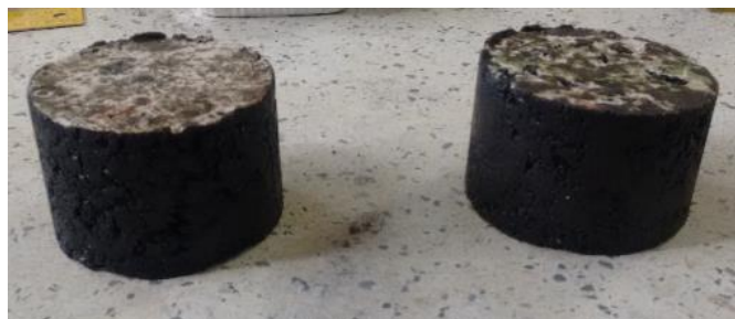
Figura 15. Mezcla asfáltica compactada.
