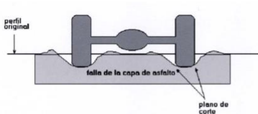
Figura 3. Ahuellamiento por falla en la mezcla asfáltica.
