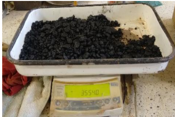
Figura 12. Mezcla asfáltica sin compactar para el cálculo de Gmm.
