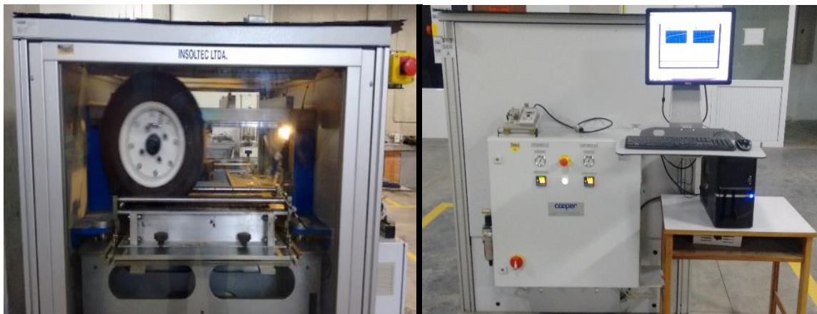
Figura 21. Máquina de ahuellamiento en funcionamiento (wheel tracker en 12697-22 large device).
