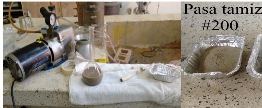
Figura 10. Llenante mineral en el proceso para el cálculo de la gravedad específica.
