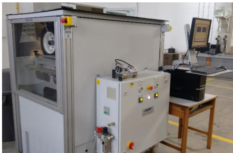
Figura 18. Máquina de ahuellamiento.
