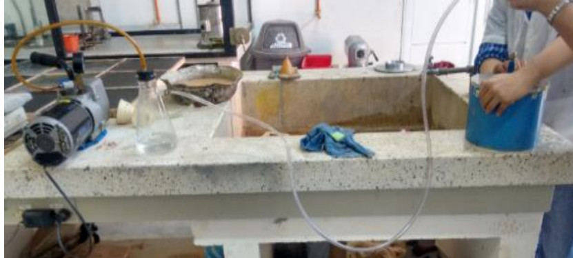
Figura 13. Mezcla asfáltica sin compactar en el proceso para el cálculo de Gmm.
