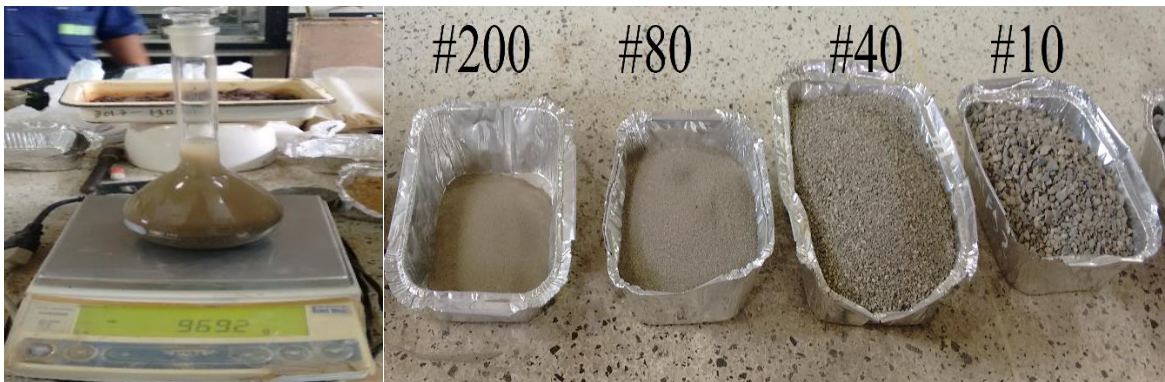
Figura 9. Agregado fino en el proceso para el cálculo de la gravedad específica.
