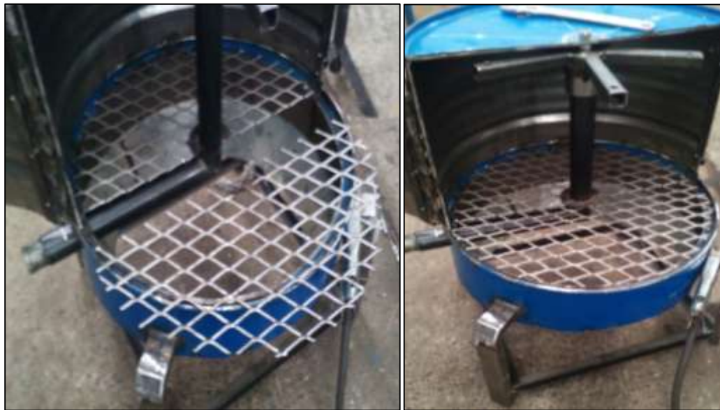
Figura 56. Ensamblaje tubería central y tapiz
