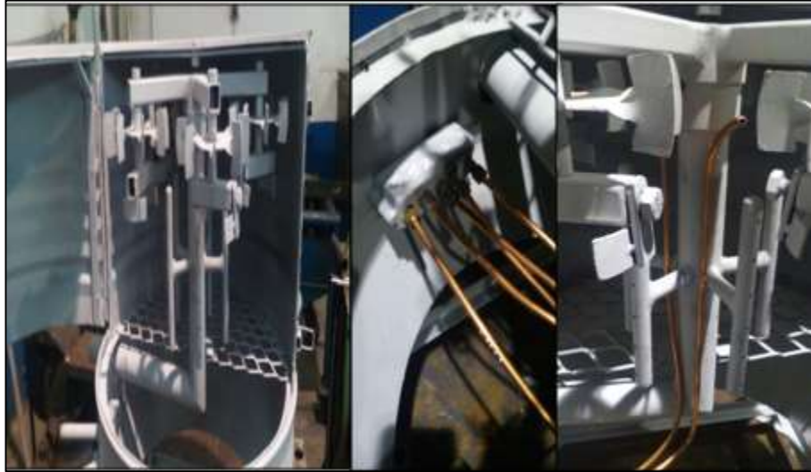
Figura 57. Ensamblaje tubería-carrusel, manifold de inyección y tubería de propulsión
