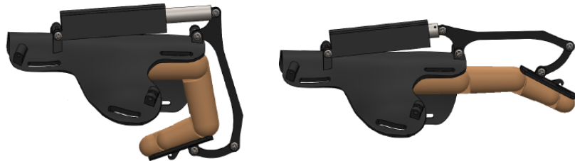
Figura 14: Sistema de flexión del exoesqueleto.
