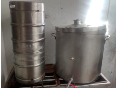
Ilustración 12. Equipo para llevar a cabo el proceso de hervido
