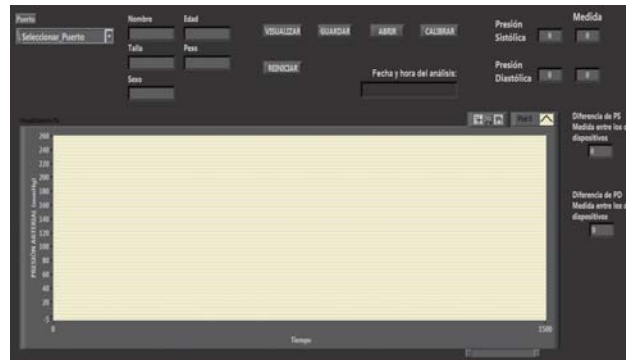
Figura 20. Panel frontal visualizador de presión arterial diseñado en Labview.
