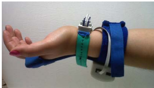
Figura 16. Dispositivo de monitoreo de la presión arterial.
