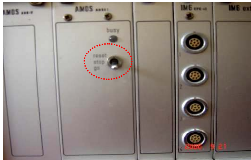
Switch 2 del panel frontal de la Estación de Trabajo Electroquímica Zahner IM6
