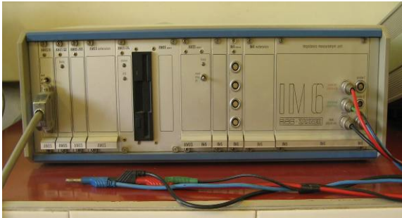
Vista frontal de la Estación de Trabajo Electroquímica Zahner IM6
