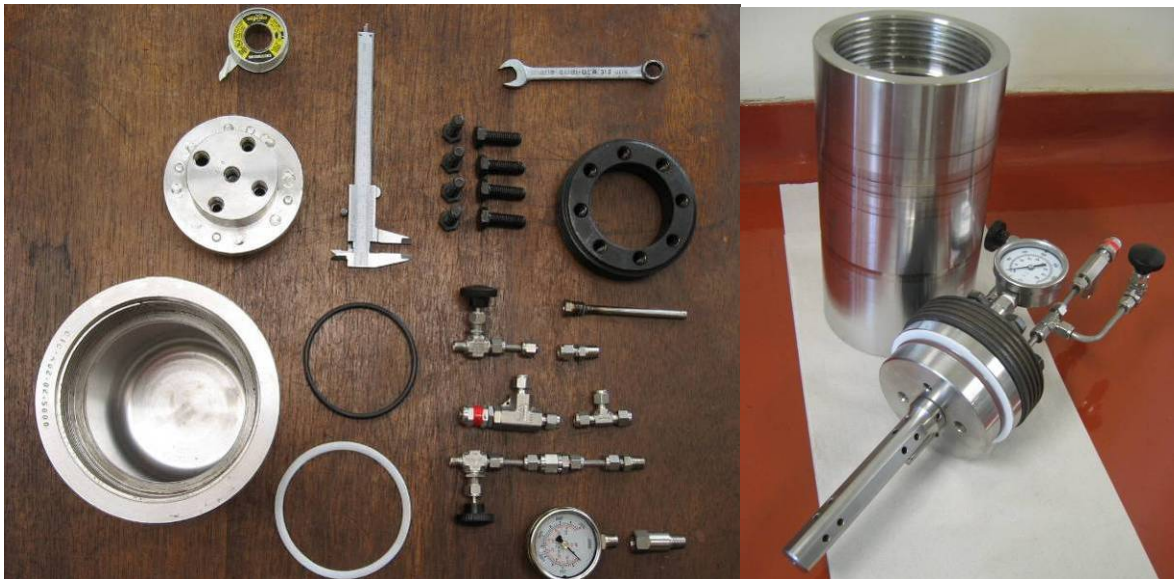
Fotografía 2. Cuerpo, cabezal y accesorios del Autoclave.
