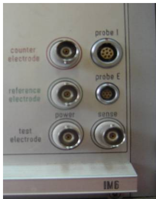
Salidas de los conectores de la Estación de Trabajo Electroquímica Zahner IM6
