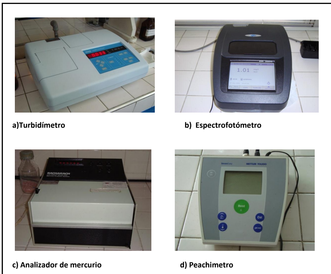
Figura 6 Equipos para medición de algunas variables presentes en el agua Fuente: Autores
