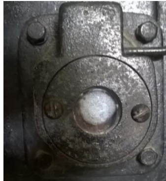
Figura 66. Detalle empañamiento mirilla posterior.
