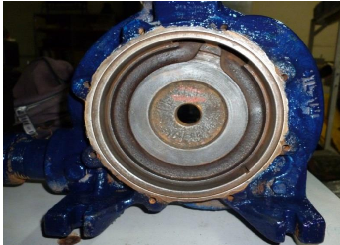
Figura 41. Cuerpo de la bomba con mantenimiento.
