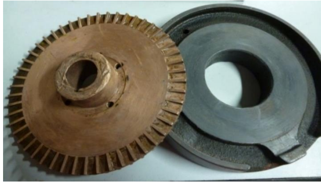
Figura 37. Rodetes y tapas post mantenimiento.
