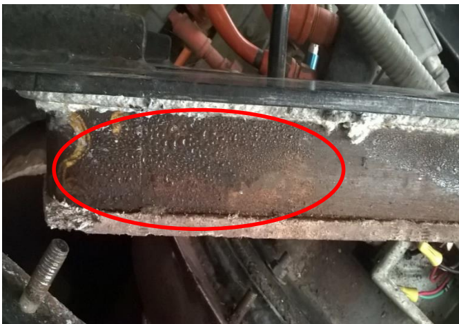
Figura 67. Detalle condensado en el lado del fuego.
