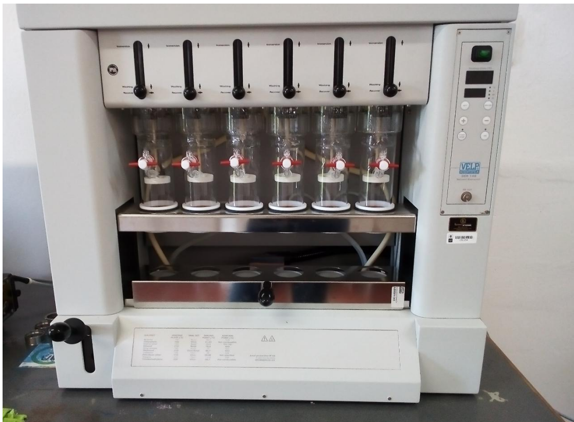
Apéndice 13. Extracción de grasas en extractor Marca Velp
