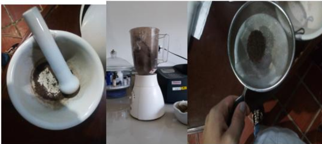
Apéndice 11. Macerado, triturado y tamizado del material
