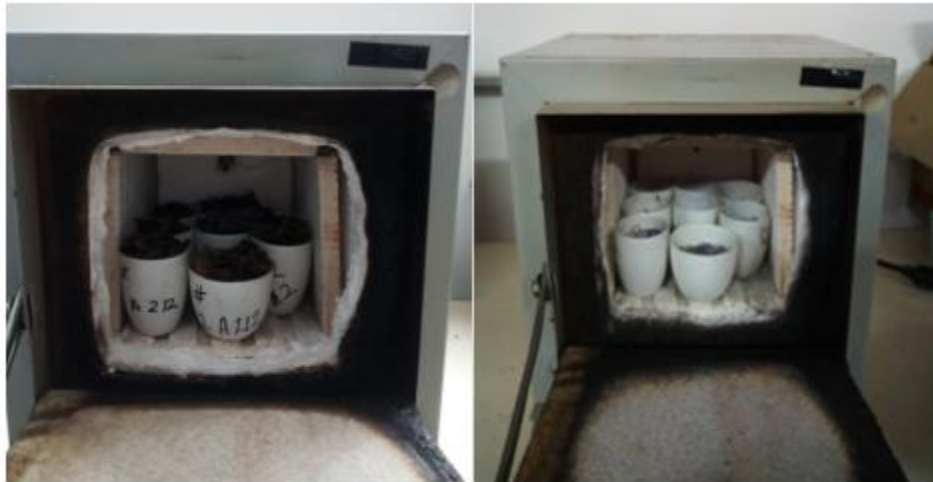
Apéndice 10. Calcinación del material
