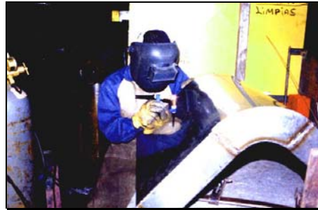
1. Soldadura de argón para cuerpo de inoxidable.
