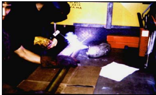
2. Soldadura de tubo de bronce con codo en inoxidable.
