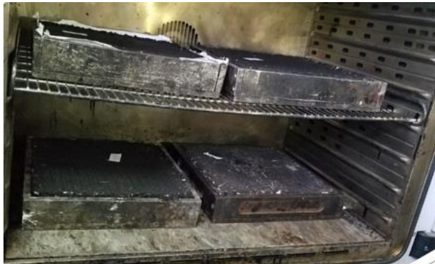
Fotografía 6. Probetas en horno a 60 \pm 2^{\circ}\text{C} antes del ensayo de Ahuellamiento
