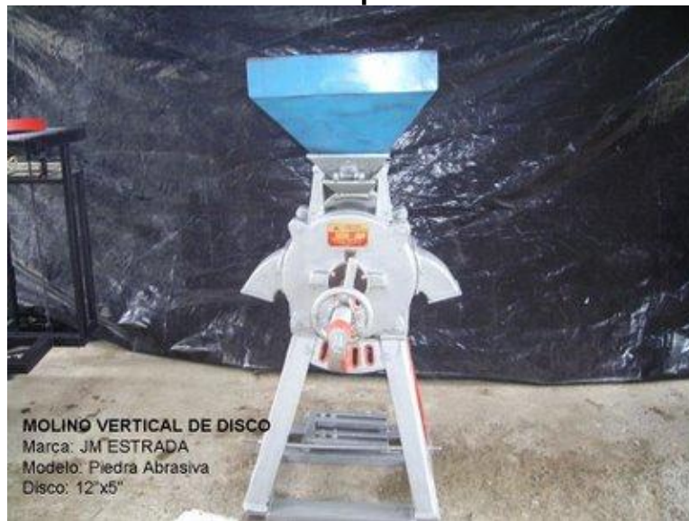
Figura 18. Molino vertical de disco con piedra abrasiva
