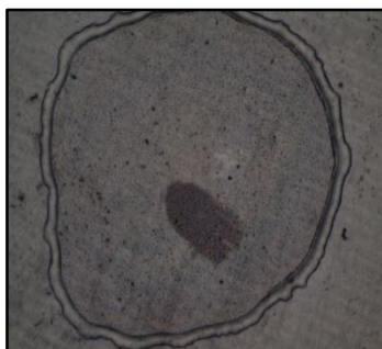
Figura 9. Micrografía del recubrimiento de PMMA/C 2 H 4 CL 2 0.3 %p/v realizado por spin coating .
