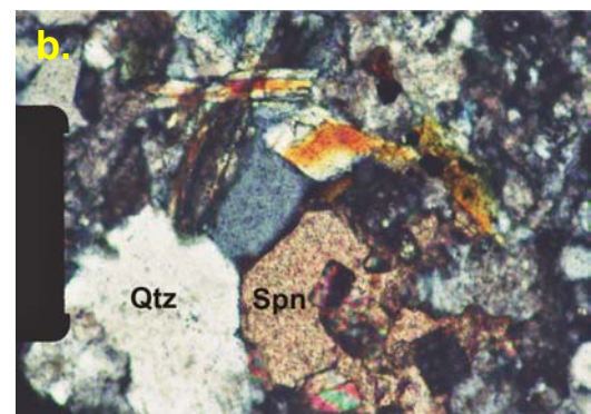
Figura 17. Esfena subhedral junto al cuarzo y clinozoisita. Aumento 8X. a. Nícoles paralelos; b. Nícoles cruzados.
