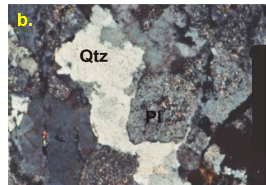
Figura 12. a. Cuarzo anhedral asociada a plagioclasa y feldespato potásico. Nícoles cruzados. Aumento 5X b. Cuarzo anhedral e intersticial. Nícoles cruzados. Aumento 8X.
