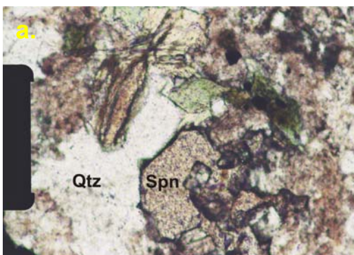
Figura 17. Esfena subhedral junto al cuarzo y clinozoisita. Aumento 8X. a. Nícoles paralelos; b. Nícoles cruzados.
