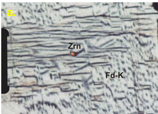
Figura 20. a. Feldespato potásico con textura gráfica; en el centro circón redondeado (Textura Poiquilitica). Nícoles cruzados. Aumento 10X; b. Textura antipertítica. Nícoles cruzados. Aumento 10X.
