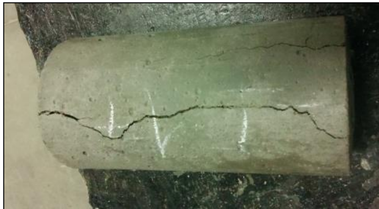
Imagen 6. Cilindro fallado a tensión indirecta.
