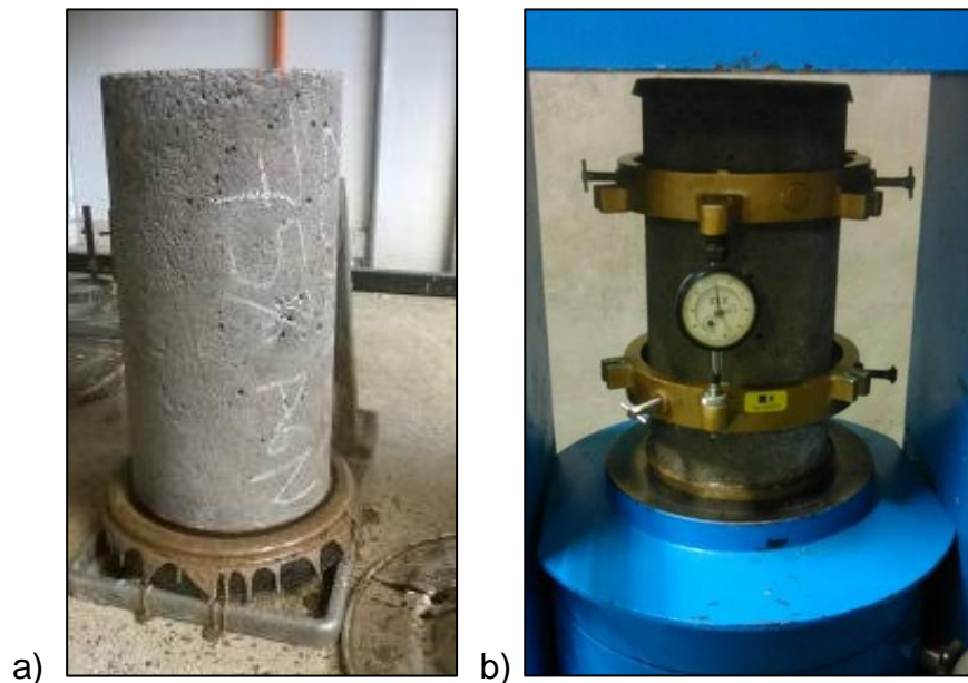
Imagen 7. Equipo para el módulo de elasticidad (a) espécimen 150 x 300 mm en el cabeceador de plato fijo, (b) Indicador de cuadrante para medir la deformación.
