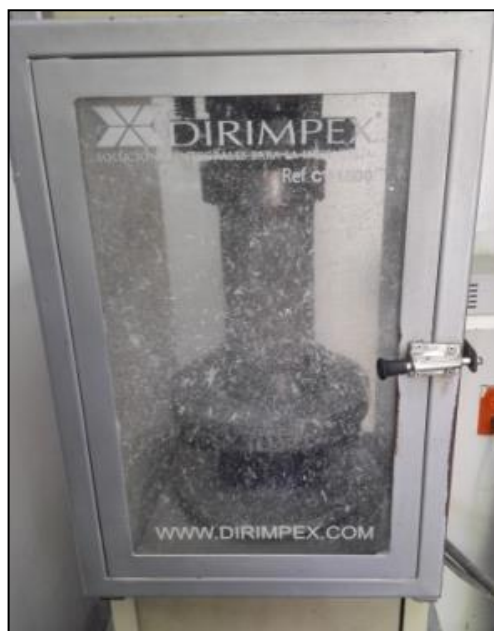
Imagen 3. Ensayo de compresión a los 28 días.
