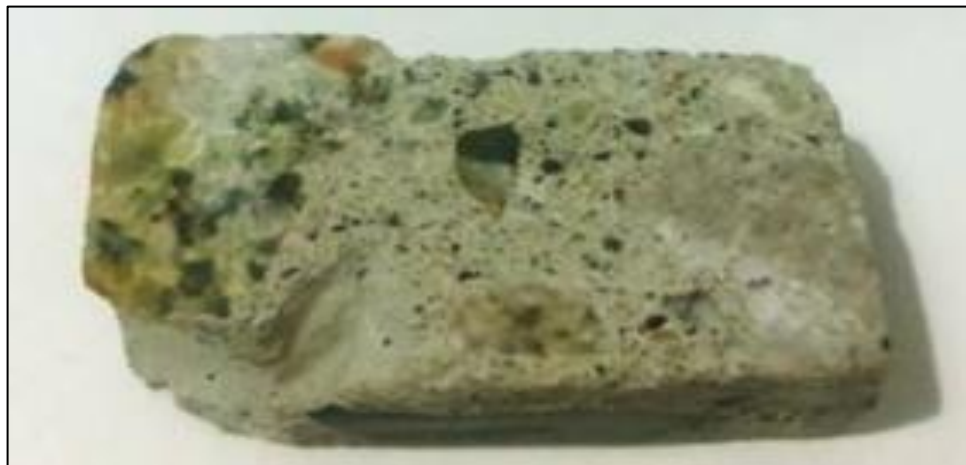
Imagen 14. Muestra de concreto óptimo pulida.
