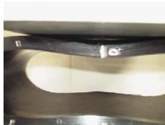
**B.5.13 Criterio usado para la finalización del ensayo.** El criterio usado para finalizar el ensayo fue el pandeo en la pared o corbatín y la incapacidad del tubo para seguir soportando incrementos de carga.
