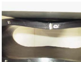
**B.4.14 Criterio usado para la finalización del ensayo.** El criterio usado para finalizar el ensayo fue el pandeo en la pared o corbatín y la incapacidad del tubo para seguir soportando incrementos de carga.
