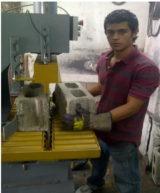
Figura 73. Bloque de concreto h15 después del corte
