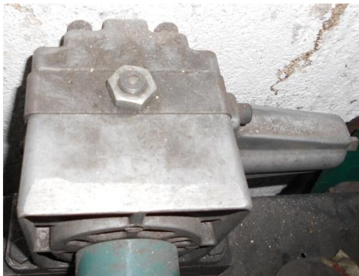
Figura 20. Bomba hidráulica de engranajes
