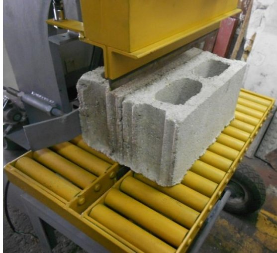
Figura 72. Montaje del bloque h15 para su respectivo corte
