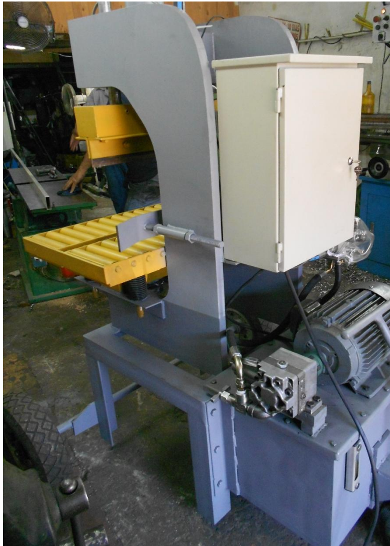
Figura 69. Montaje del tablero de control
