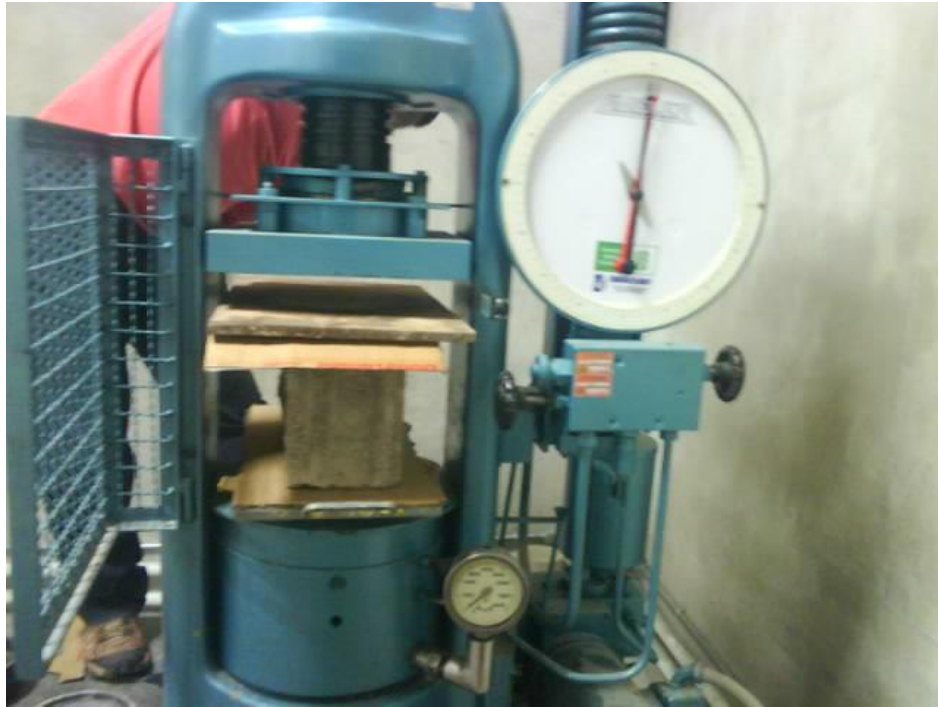
Figura 74. Máquina de ensayos a compresión del laboratorio de civil
