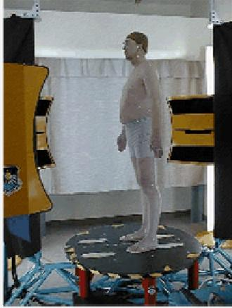
Este sistema de scanner permite recolectar datos tridimensionales de las personas como superficies, contornos y áreas del cuerpo humano, además de los segmentos entre los puntos antropométricos que se obtienen con las herramientas tradicionales. Al individuo se le adhieren marcas blancas que sirven de referencia en los puntos antropométricos y que quedan registrados durante el scaneado. La persona tiene que situarse en la plataforma del scanner ya sea sentada o parada por sólo 17 segundos.
