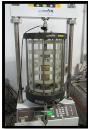
Figura 7. Montaje en el ensayo triaxial (CU).
