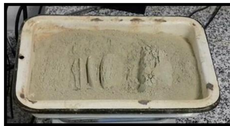
Figura 6. Mezcla suelo (Bentonita)-carbonato de calcio al 9%, con el tiempo de curado cumplido.
