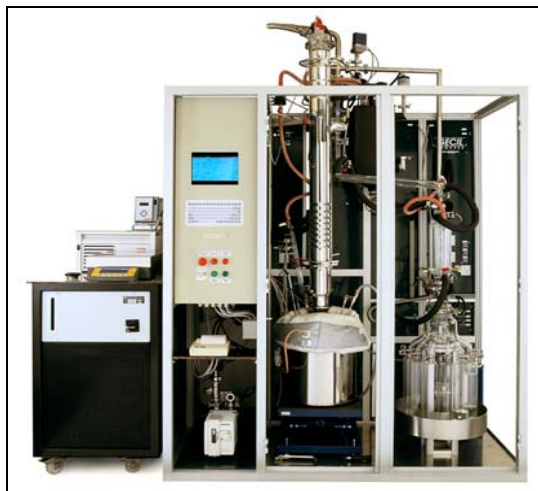
Figura 4. Equipo de destilación a nivel de laboratorio. Ubicado en el Instituto Colombiano del Petróleo
