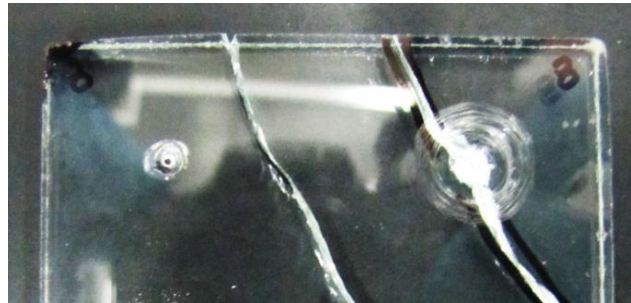
Figura 7. Huella dejada por el indentador a diferentes velocidades de prueba.
