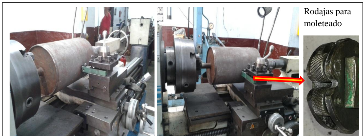
Figura 116. Fabricación de rodillos inerciales
