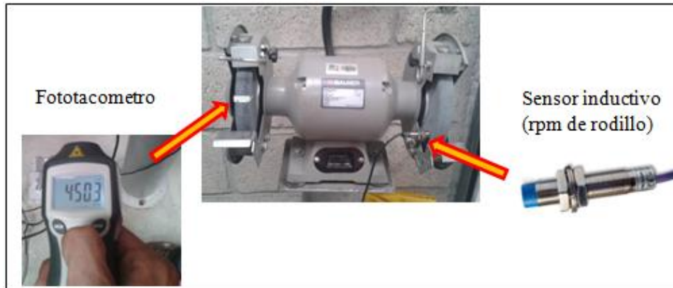
Figura 114. Caracterización del sensor de rpm de rodillo
