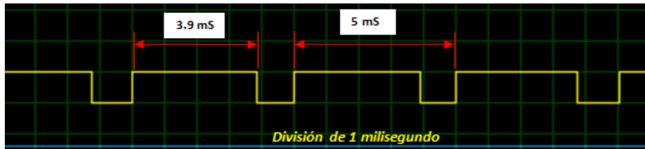
Figura 97. Resultados de la simulación para la rutina de medición de potencia
