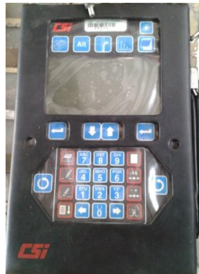
Figura73. Analizador de vibraciones CSI
