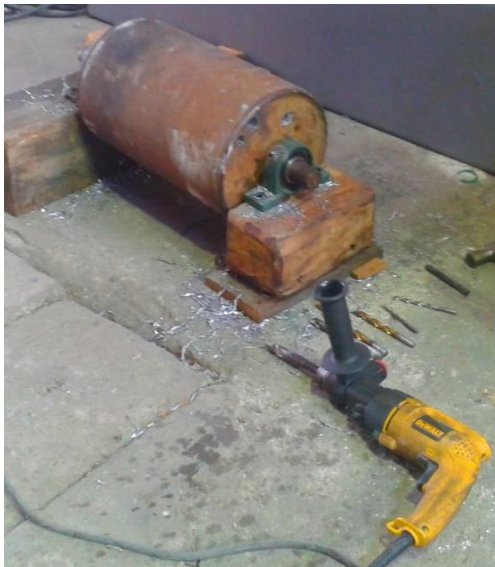
Figura 71. Procedimiento de balanceo mediante retiro de material
