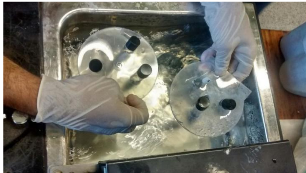
Figura 106. Baño termostático para sostener la temperatura de las muestras.
