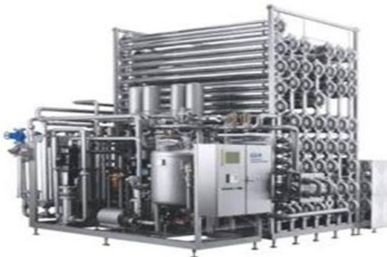
Figura 12. Planta de tratamiento de leche para proceso UHT.
