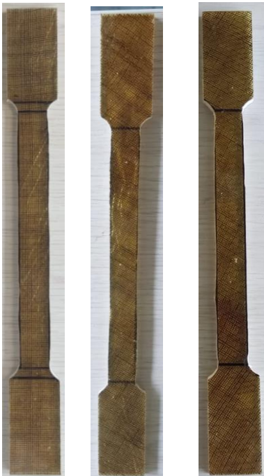
Figura 10 probetas de fique a 0, 45 y 60°
