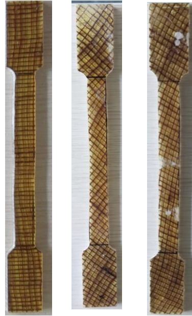
Figura 7 probetas de yute a 0, 45 y 60°
