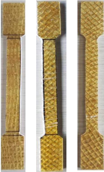
Figura 8 probetas fique a 0, 45 y 60°
