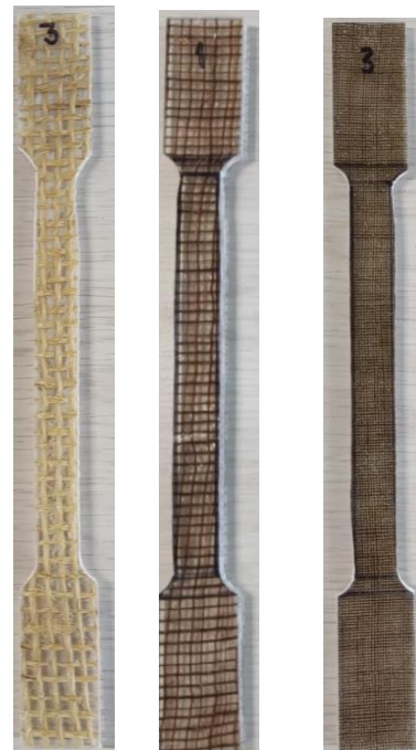
Figura 9 probetas de fique, lino y yute con epoxi
