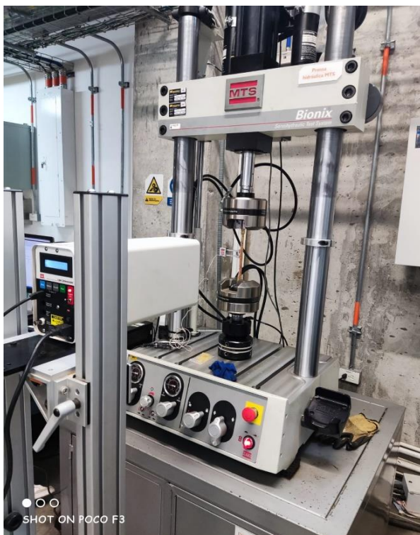
Figura 13 Ensayo de tensión
