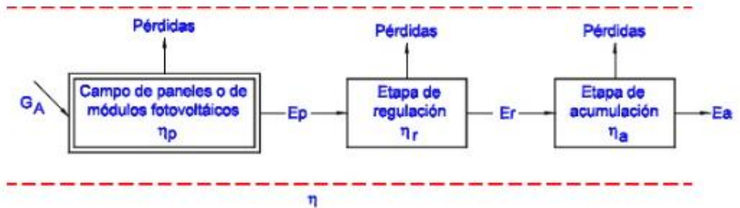
Figura 13. Representación esquemática de un sistema solar fotovoltaico con sus flujos de energía a través de las diferentes etapas del sistema.
