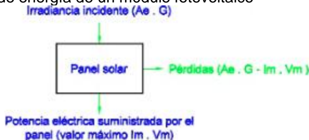
Figura 9. Balance de energía de un módulo fotovoltaico
