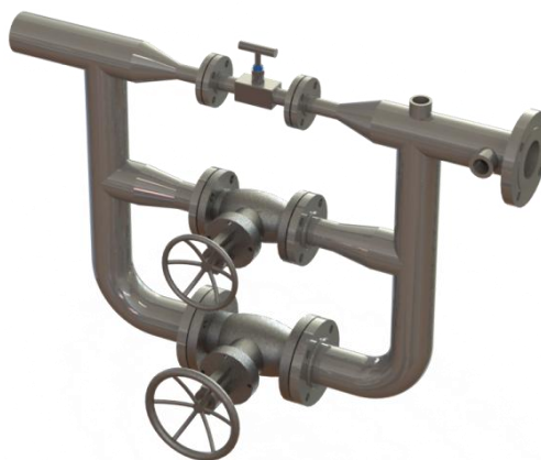
Figura 27. Sistema de Regulación Manual.- CAD
