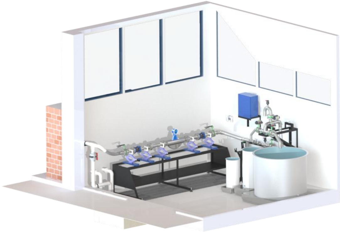
Figura 42. Banco de Calibración - Modelo CAD
