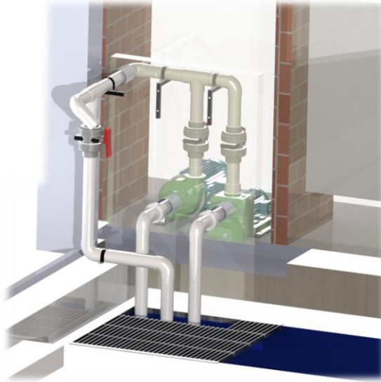
Figura 33. Sistema de Bombeo – CAD
