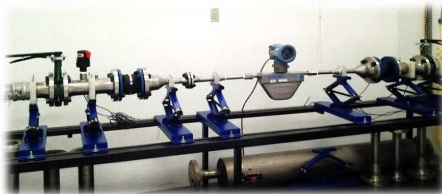
Figura 62. Calibración Medidor Másico CNG50
