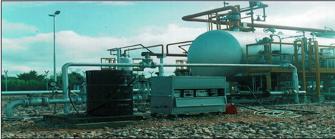
Figura 36. Prototipo de tratamiento magnético, campo Dina Terciarios.
