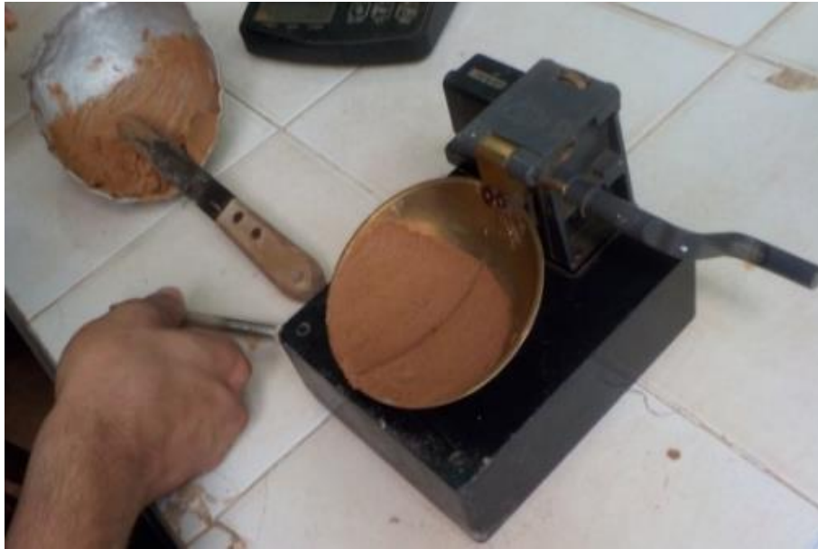
Figura 8. División de la muestra sobre cazuela de bronce
