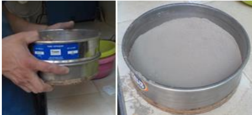
Figura 7. Material pasante del tamiz No. 40
