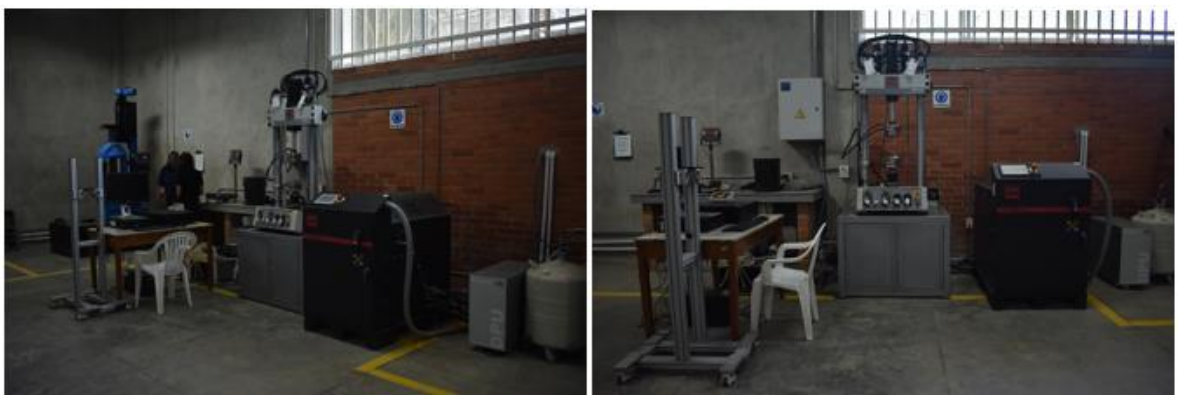
Figura 19. Maquina universal de ensayos mecánicos MTS-Bionix 370.02.
