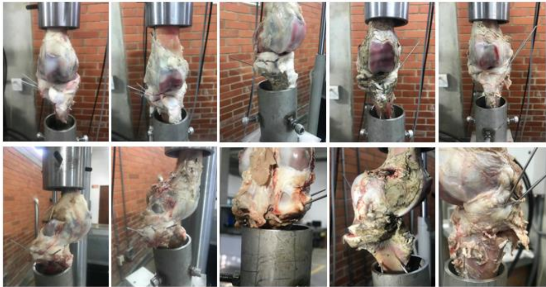
Figura 21. Falla en el conjunto hueso – elemento por fuerzas de compresión pura generados por la máquina universal de ensayos MTS-Bionix 370.02.
