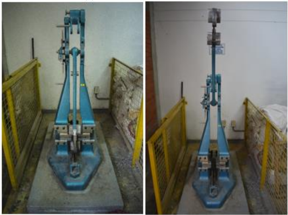
Figura 13. Máquina de ensayos a impacto TREBEL o péndulo de CHARPY.
