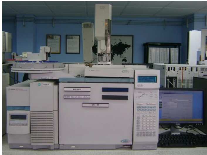
Figura 20. Cromatógrafo de gases Agilent Technologies 6890 Plus Series GC System acoplado a un detector selectivo de masas Agilent Technologies 5973 Network , equipado con un puerto de inyección split/splitless y un inyector automático Agilent 7863 . Fotografía tomada en el Laboratorio de Cromatografía de la UIS, el 17 de noviembre de 2010.
