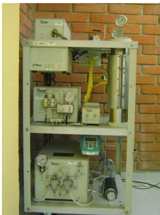
Figura 19. Extractor SFE-2000 (Thar technologies, Pittsburgh EE.UU.). Fotografía tomada en CENIVAM, el 17 de noviembre de 2010.
