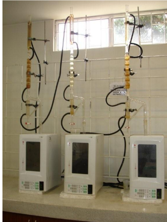
Figura 18. Montaje para hidrodestilación asistida por microondas. Fotografía tomada en CENIVAM, el 17 de noviembre de 2010.
