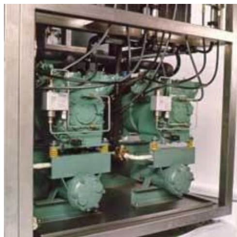
Figura 27. Detalle compresores de doble etapa. Fuente: www.etelstar.com
