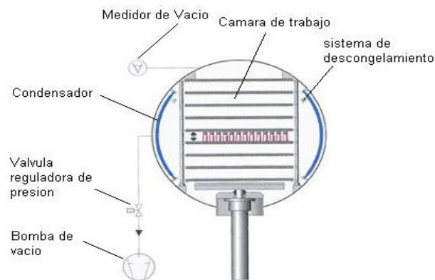
Figura 11. Sistema de simple cámara cilíndrica.
