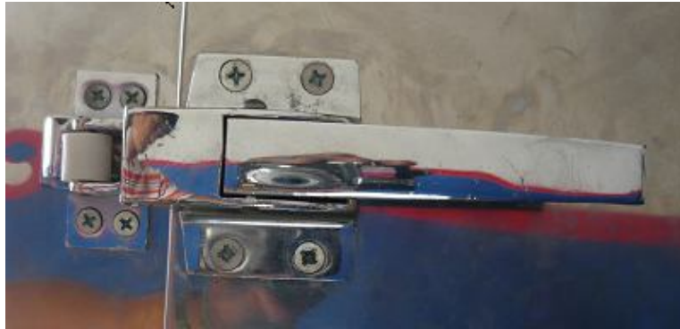
Figura 72. Manijas de seguridad de la puerta de la cámara.
