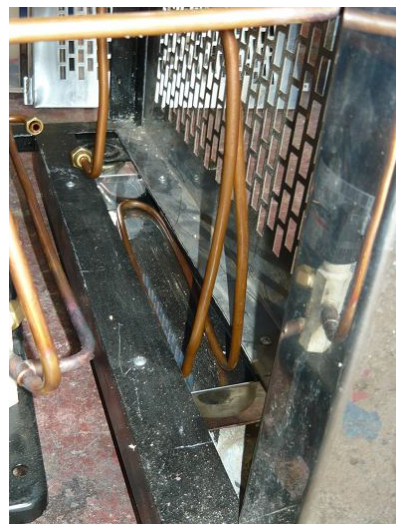
Figura 90. Recipiente de reevaporación exterior.
