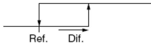
Figura 60. Diferencial de temperatura del controlador EKC 201 de Danfoss.
