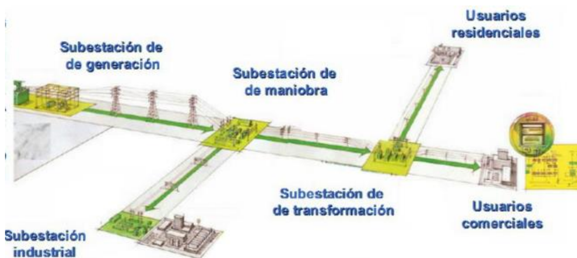
Figura 26. Tipos de subestaciones eléctricas
