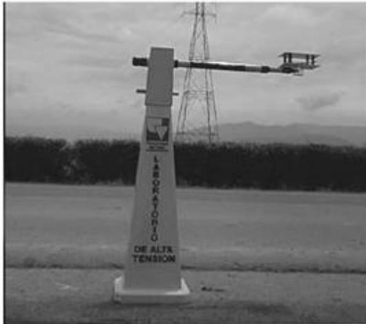
**Figura 2.4** Configuración que permite sostener el medidor de intensidad de campo eléctrico en una posición correcta, conservando la altura estipulada en la norma (1 m) y manteniendo una distancia prudente al observador para minimizar el efecto de proximidad. Tomado de [4].
