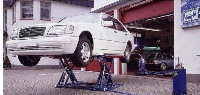
Figura 16 Elevador móvil, monocolumna, hidráulico.
