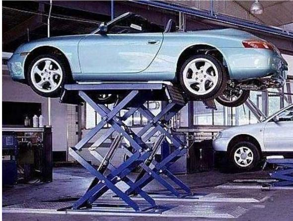
Figura 11 Elevador Fijo, tijera simple, hidráulico.
