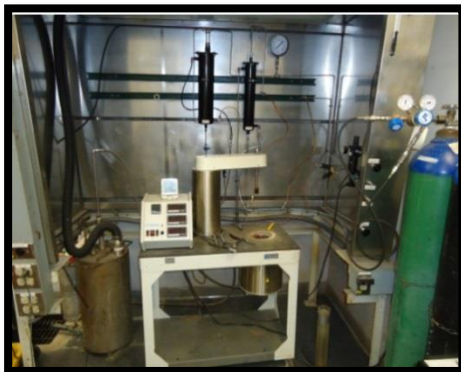
Figura 7. Configuración del Autoclave para la realización de las pruebas POX.
