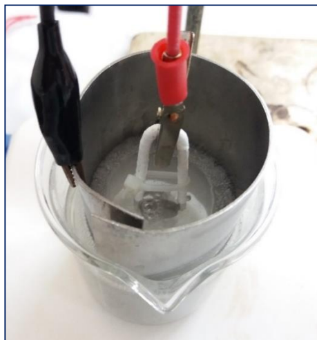
Figura 2. Configuración de la celda utilizada en el proceso anodizado de la aleación Ti6Al4V.
