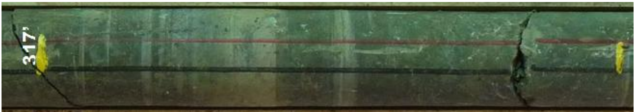
Figura 71. Detalle de finas concreciones de calcita en limolita, 317' de profundidad
