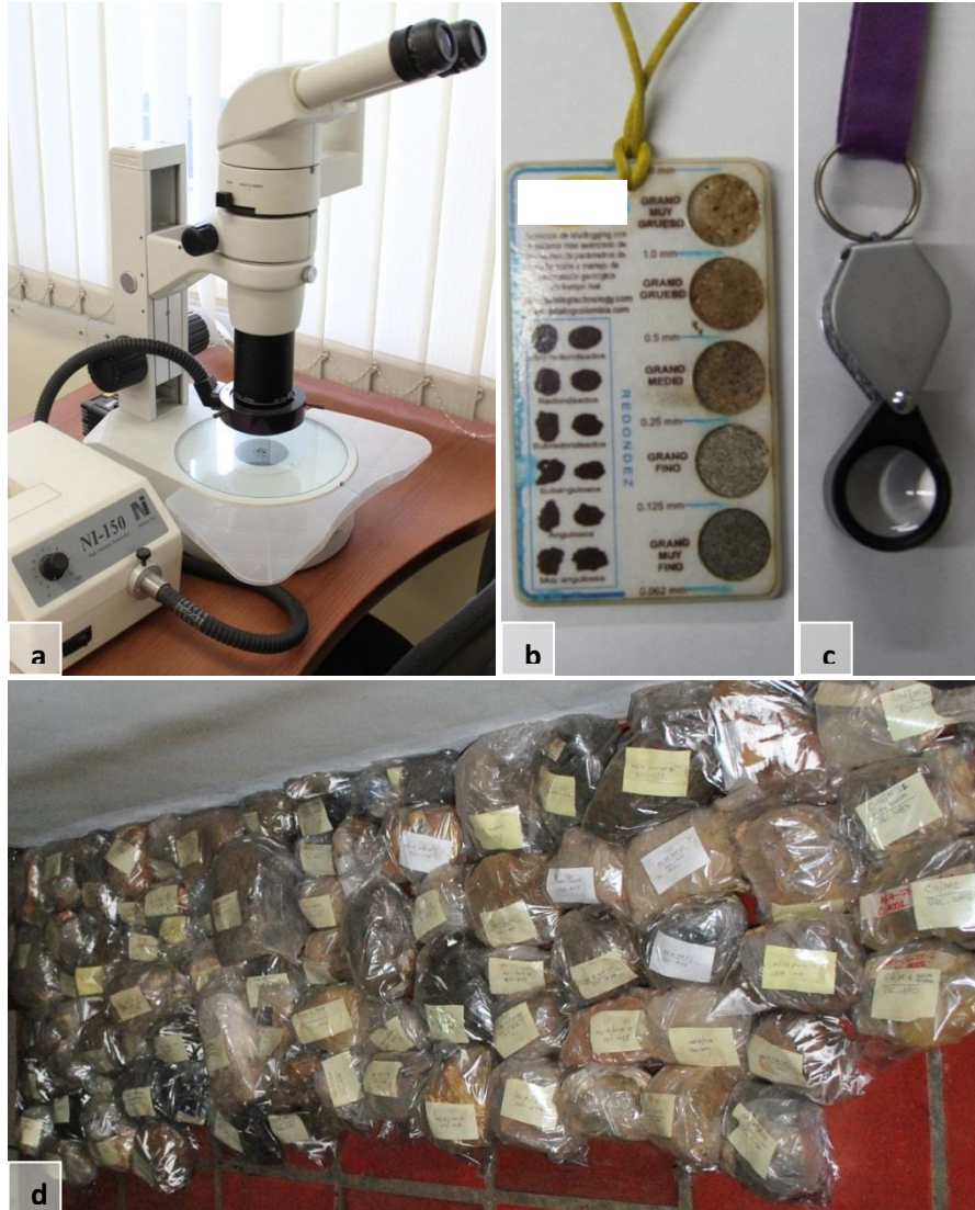
Figura 3. Elementos de apoyo para la descripción macroscópica de las muestras obtenidas en campo. a. Estereomicroscopio marca Nikon SMZ 800. b. Tabla granulométrica. c. Lupa de mano de 20X de aumento. d. Muestras de mano recolectadas en campo.
