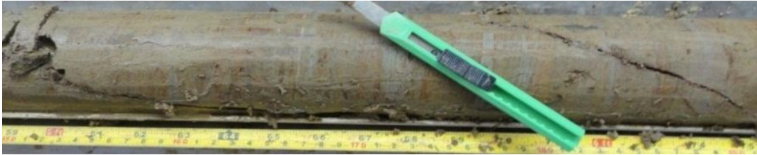
Figura 79. Limolita moteada con alto contenido de carbonato como cemento, 318' de profundidad
