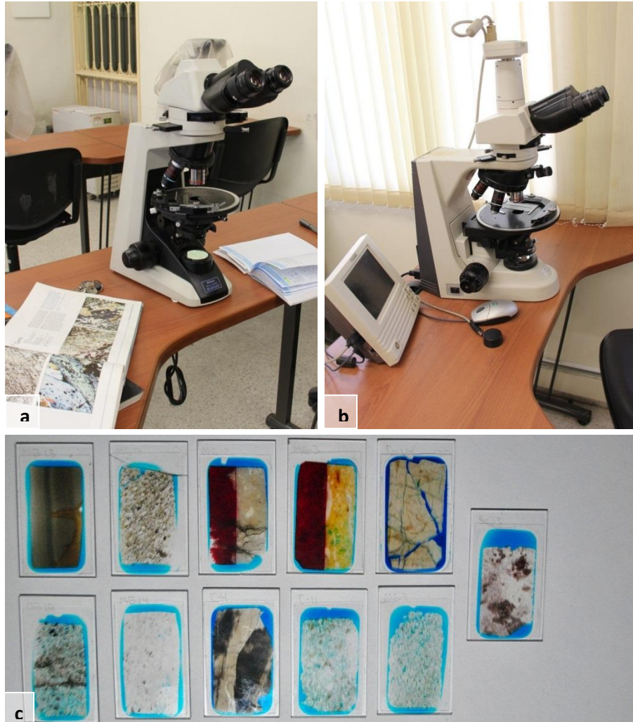
Figura 4. Elementos de apoyo para la descripción microscópica de las muestras obtenidas en campo. a y b. Microscopio marca Nikon Eclipse E200. c. Secciones delgadas descritas.
