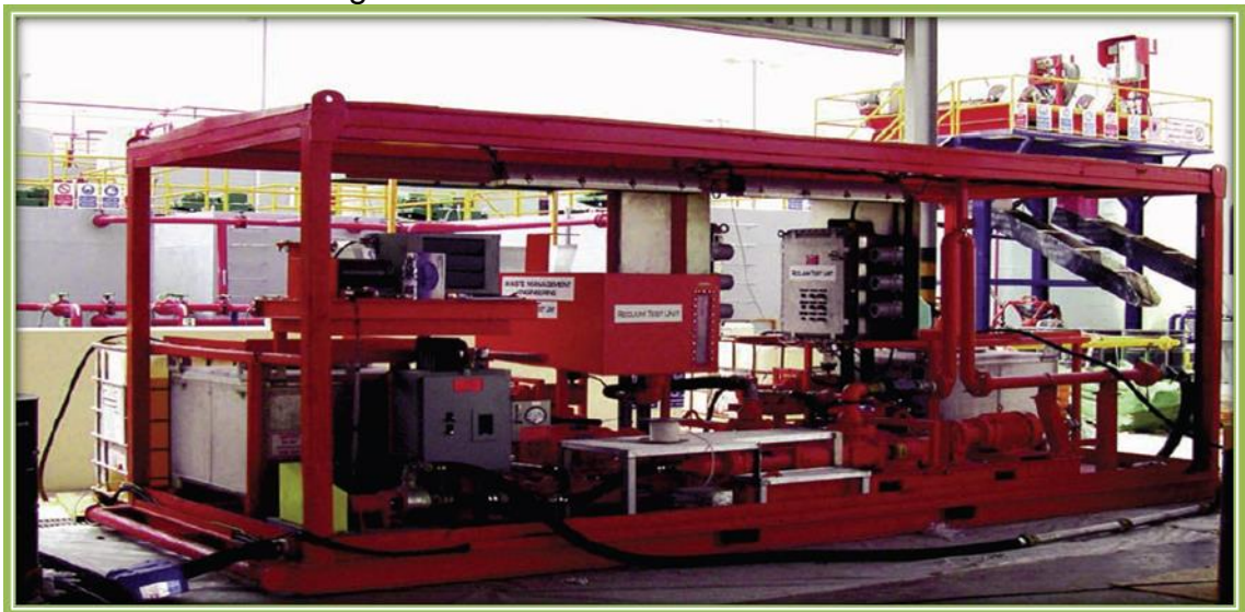
Figura 4. Unidad de tratamiento RECLAIM
