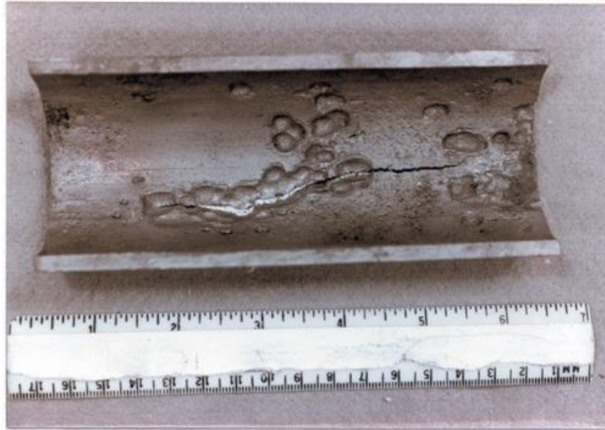
Figura 19. Corrosión localizada en tubería metálica
