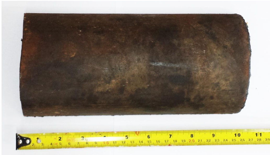
Figura 63. Sección externa de tubería API 5CT tamaño 4 ½ 12.75#
