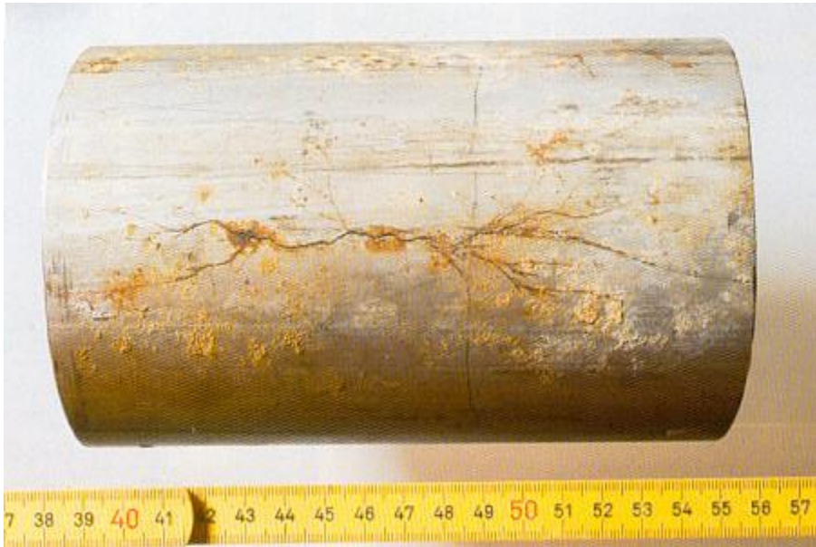
Figura 11. Agrietamiento de corrosión por esfuerzo
