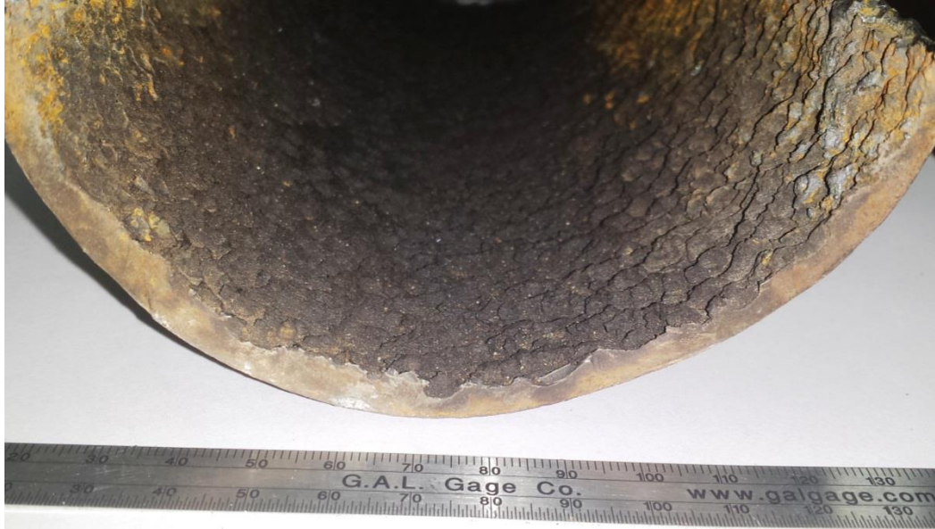
Figura 65. Sección interna de tubería corroída API 5CT tamaño 4 ½ 12.75#
