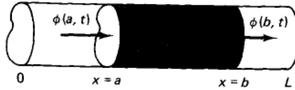
Figura 2.2: Flujo de energía en un volumen de control.
