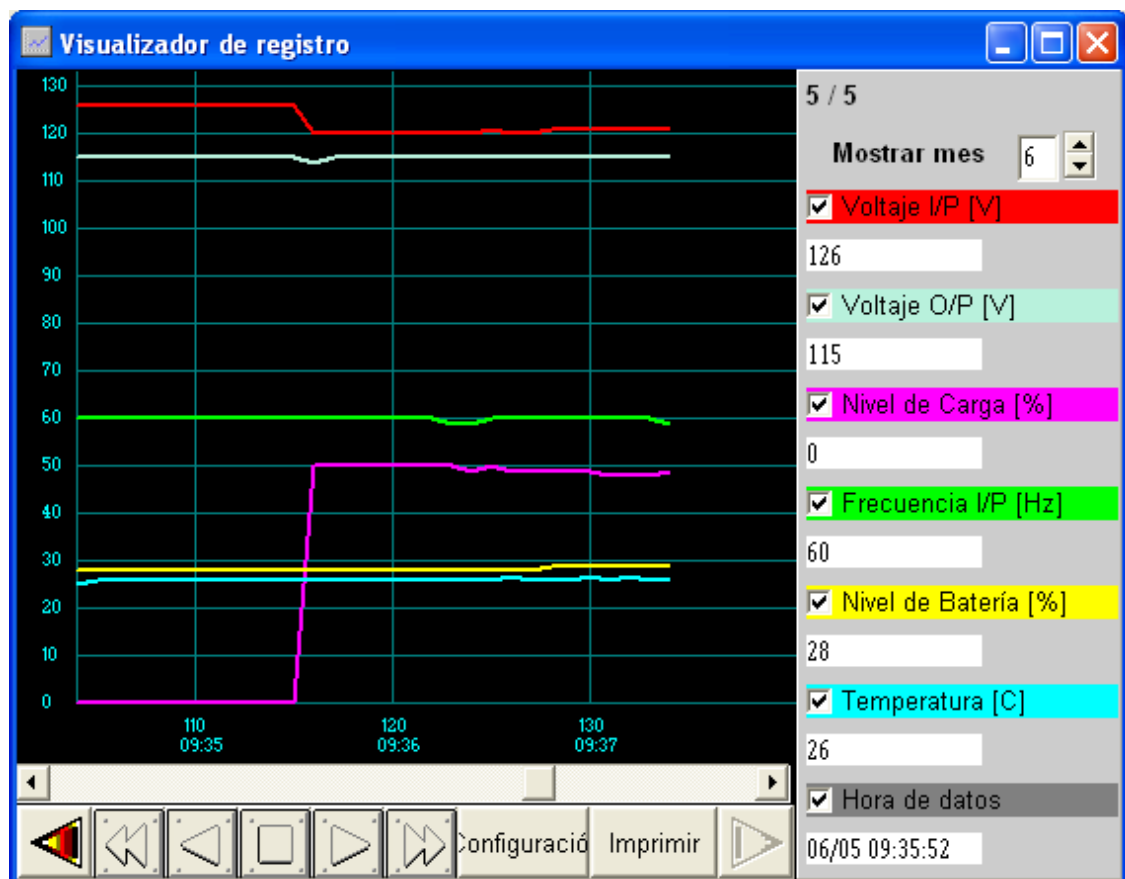
Figura 5.7 Comportamiento de los distintos valores al momento de conectar la carga
