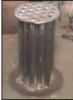
Figura 31. Intercambiador de Calor
