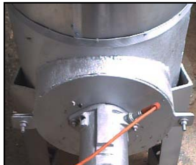
Figura 34. Cámara de Combustión
