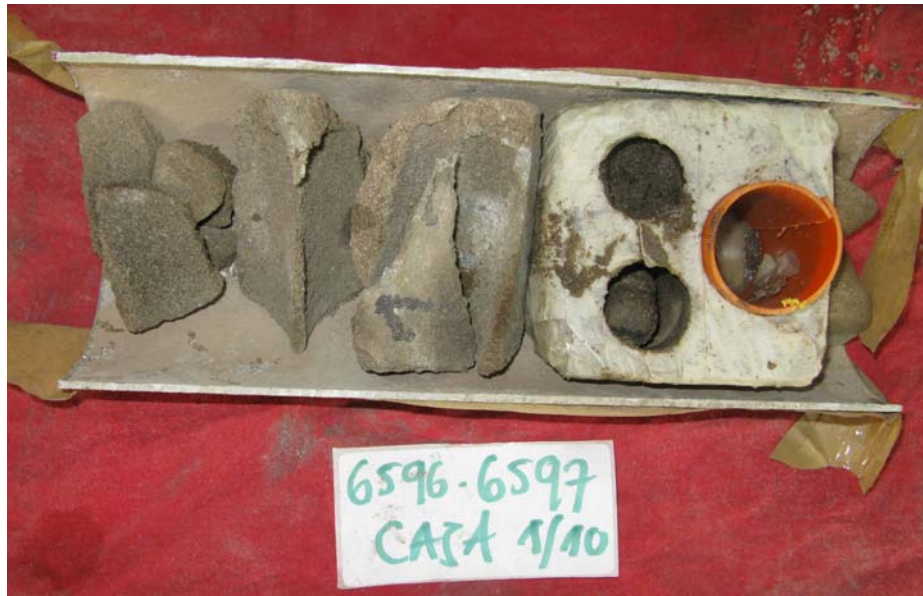
Figura 85. Núcleo de la formación Mugrosa correspondiente al intervalo 6596 a 6597.
