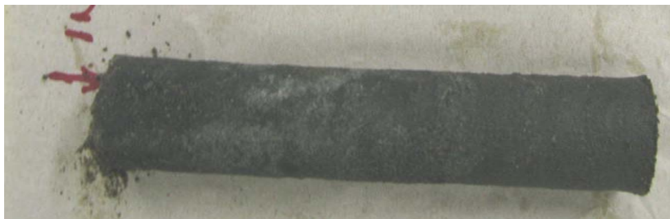
Figura 82. Plug formado a partir de arena suelta de la formación después del tratamiento resínico.
