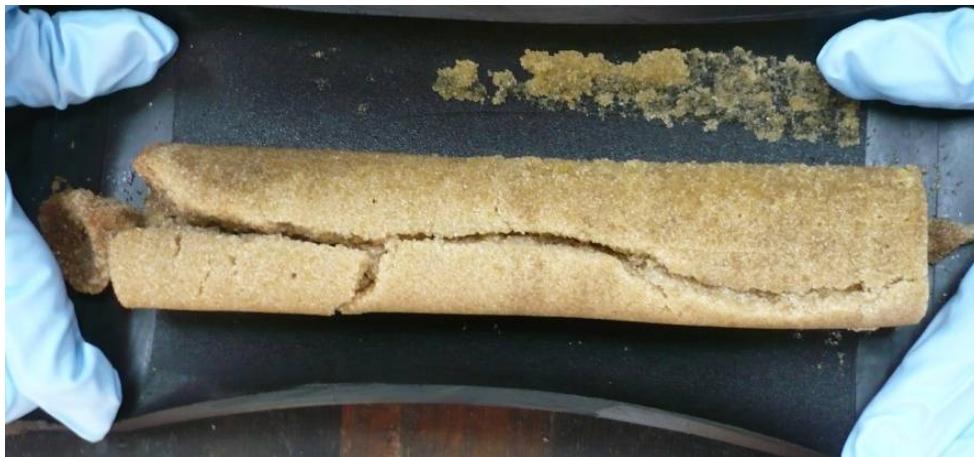
Figura 61. Vista general del segundo plug sintético consolidado arena 20/40.
