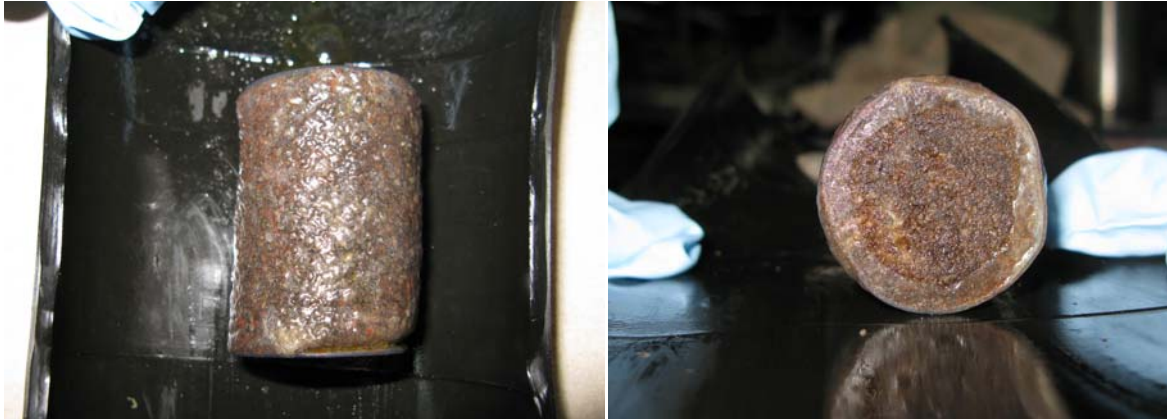
Figura 87. Plug de arena de la formación obtenido después de la consolidación, vista transversal y longitudinal.
