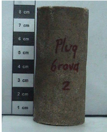
Figura 79. Porción del plug consolidado de grava 85/10/5 tomado para la prueba UCS.
