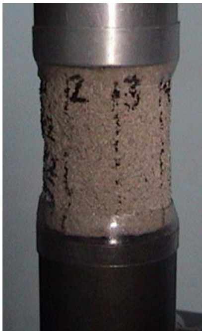
Figura 31. Plug en el equipo del ensayo UCS.
