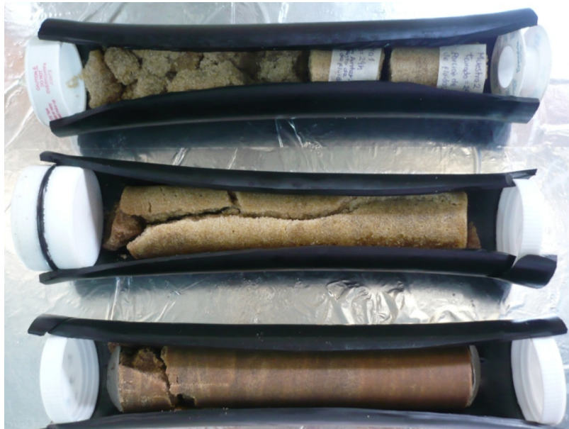
Figura 65. Comparación de las tres pruebas realizadas. El sector izquierdo corresponde a la zona de inyección de fluidos de desplazamiento; el lado derecho corresponde a la zona de salida de los fluidos de desplazamiento.
