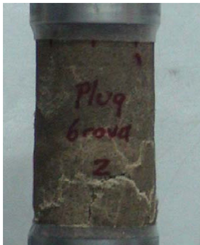
Figura 80. Plug 85/10/5 después de alcanzar el esfuerzo máximo de compresión antes del fallamiento.
