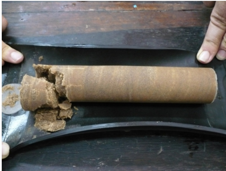
Figura 64. Plug sintético completo en la manga de caucho después de la consolidación.
