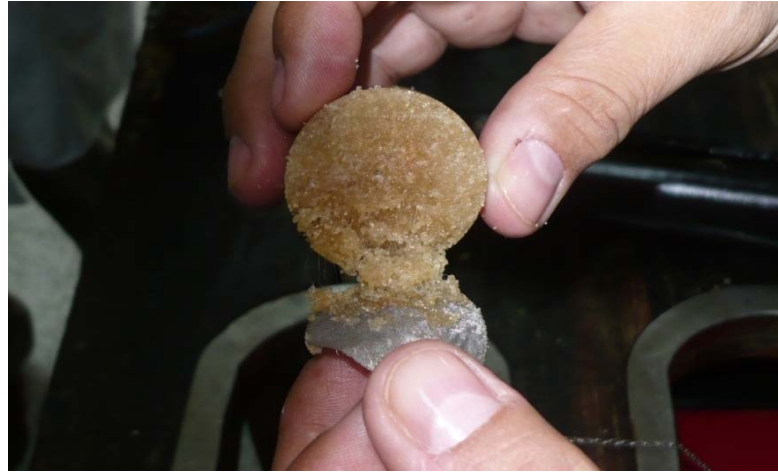
Figura 57. Fracción del plug consolidado en la primera prueba correspondiente a la parte de salida del fluido inyectado.
