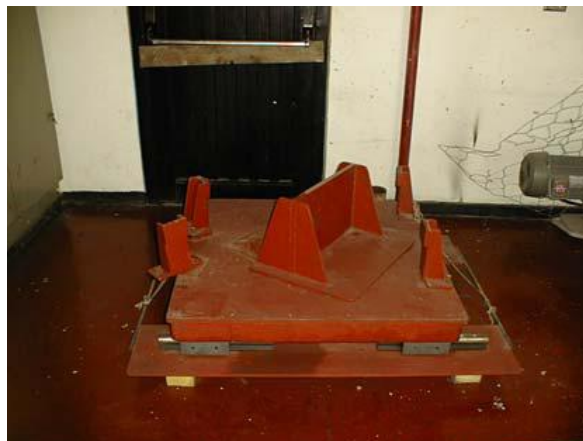
Figura 5. Simulador sísmico Universidad de los Andes. Tomado del paper. "DISEÑO Y CONSTRUCCIÓN DE LA CIMENTACIÓN PARA LA MESA VIBRATORIA DE LA UNIVERSIDAD DE LOS ANDES"
