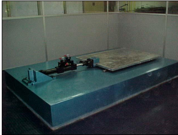
Figura 4. Simulador Univalle, Tomado del paper. "Diseño y construcción del simulador sísmico uniaxial de la universidad del valle"
