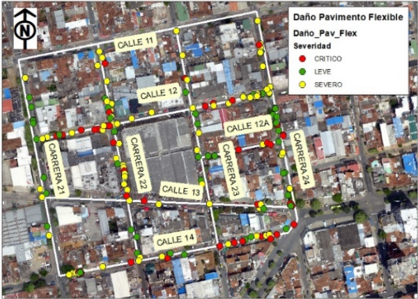
Figura 6. Localización de daños en pavimento flexible.
